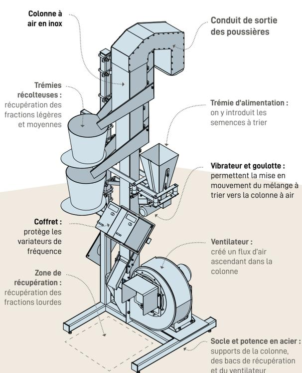
La colonne de tri utilise un flux d'air ascendant pour trier les semences et les impuretés en fonction de leur densité : plus légères, les poussières sont entraînées vers le sommet où elles sont récupérées dans un sac.
