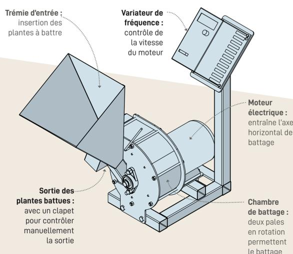
Équipée d'un moteur électrique, la batteuse permet de battre les plantes afin de récupérer les semences.
